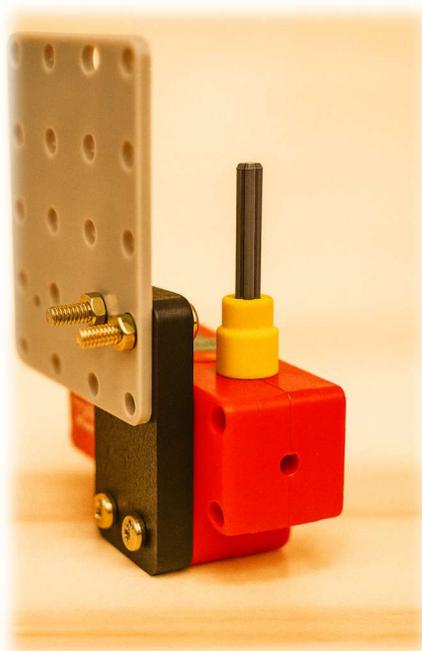
Este motor (motorreductor) possui uma **caixa de engrenagens embutida** que **reduz a velocidade de rotação e aumenta o torque** do eixo de saída.
